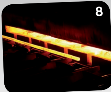
Piec do Dogrzewania Kęsisk / Kęsów
